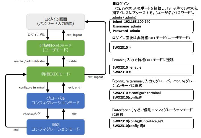
コマンド入力モードの遷移に関連する基本的なコマンドは、以下となります。 グローバルコンフィグレーション モードから個別コンフィグレーションモードへの遷移コマンドについては、コマンドリファレンスの「個別コンフィ グレーションモード」を参照してください。
