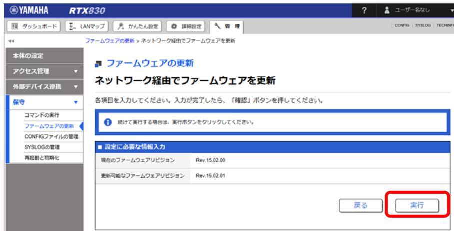
「ファームウェアの更新」ダイアログが表示され、ファームウェアの更新が開始されます。ファームウェアの更新が完了すると、本ルーターは自動的に再起動します。
