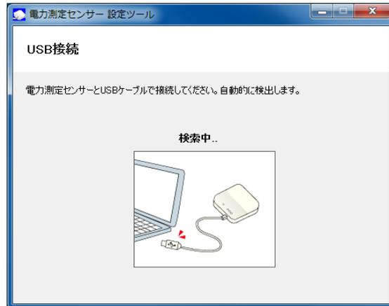
2. USB ケーブルを、パソコンの USB コネクタ (A) と本体ユニットの USB コネクタ (ミニ B) に接続します。
