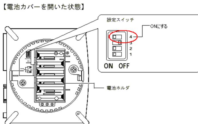
5. 停電時のために電池をセットする場合は、電池を入れ、電池カバーを閉じます。
