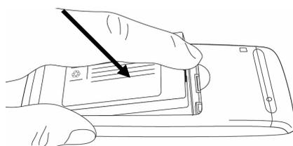
最後に、背面のカバーを本体の溝に併せ、 の方向へスライドさせ、「カチッ」と音が鳴るまで押し込みます。
