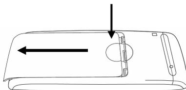
電池パックの注意書き面を上にして、電池パックと本体の金属端子が合うように取り付けます。
